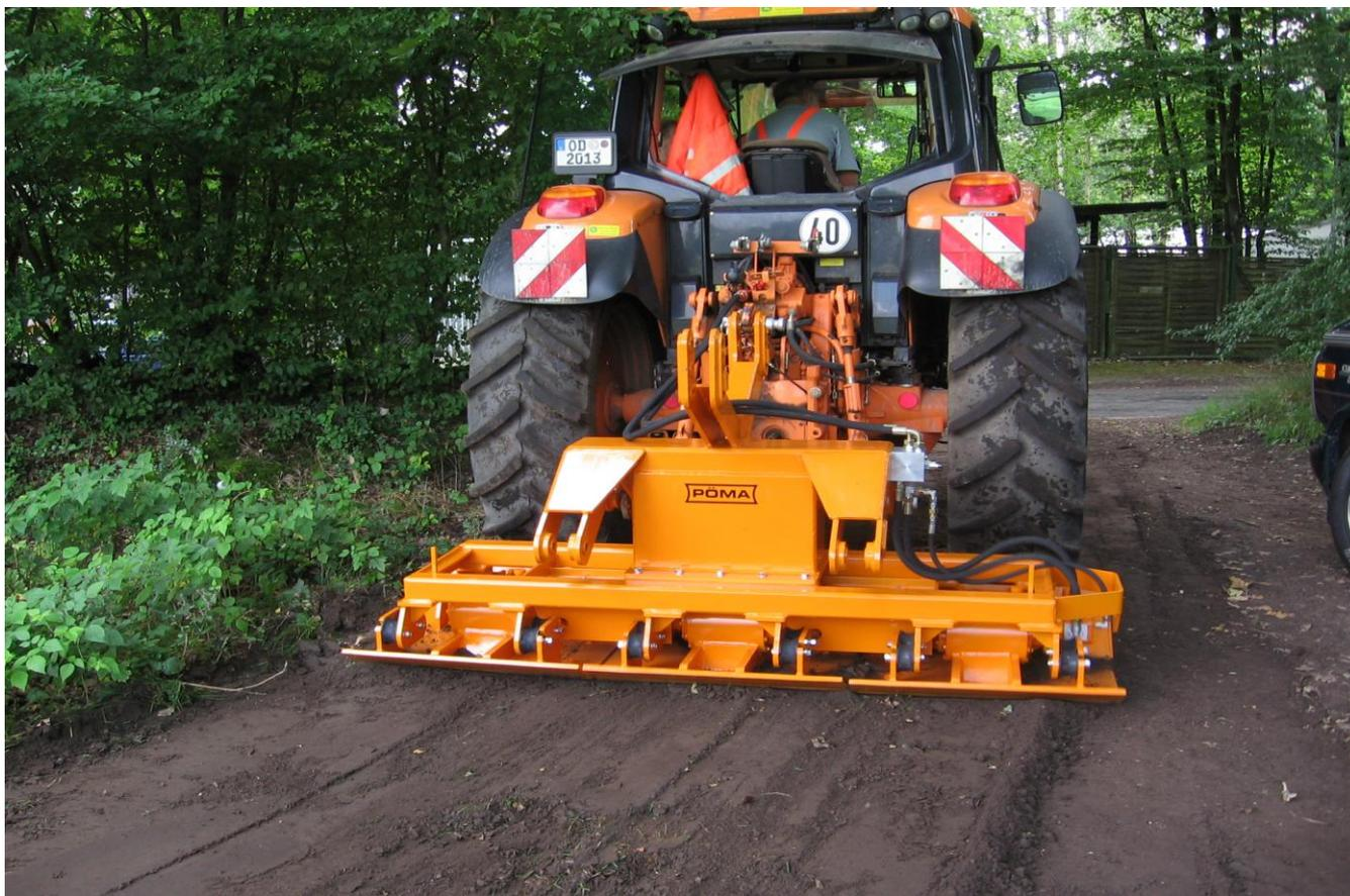
Der Antrieb des PÖMA – Plattenverdichters erfolgt über die Bordhydraulik des Trägerfahrzeuges. Der Antriebsmotor ist direkt mit der Unwuchtwellen verbunden. Keine Keilriemen, daher wesentlich geringerer Verschleiß. Die Vibrationen werden durch hochverschleißfeste Gummipuffer gedämpft. Die nach vorn hochgezogenen Platten sorgen für gleichzeitiges Nivellieren des Planums. Im Straßenbau sind mit wenigen Überfahrten hohe Werte zu erzielen.
