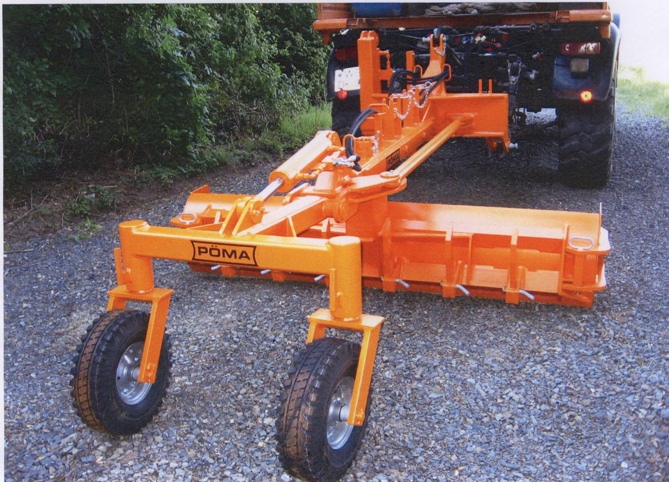
Mit dem PÖMA- Anbaugrader H 225 ESP ergänzen wir unsere seit Jahren bewährten Wegebaugeräte um ein preiswertes, professionell einsetzbares Gerät. Neu in dieser Baureihe ist die seitliche Parallelführung des Gerätes mittels einer Führungsstange. Dadurch bleiben die nachlaufenden Stützräder immer hinter dem Graderschild.
